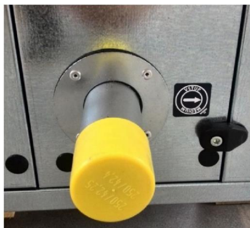
Kennzeichnung des Ausgangs des Wärmetauschers
