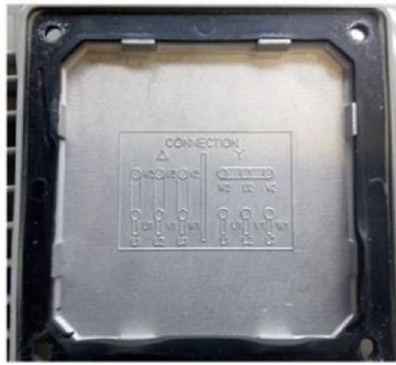
Deckel des Klemmleiste mit der Zeichnung des Schaltung der
